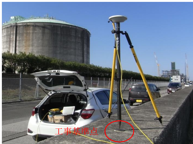
図-9 静止測量状況
